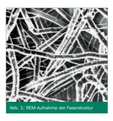
Das heißt, im Unterschied zu den beiden anderen Technologien ist das Trägermaterial für das aktive Material nicht ein schweres und steifes Metall, sondern ein sehr leichtes und flexibles Vlies.
